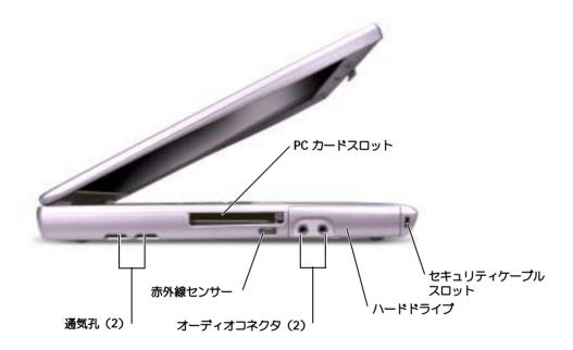
通気孔 ― コンピュータは内蔵ファンを使って、通気孔から空気が流れるようにします。これによって、 コンピュータが過熱することを防ぎます。
