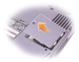
7 指をカバーの下のくぼんだ部分に置き、カバーを持ち上げてスライドさせて開きます。
