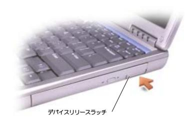
5 リリースラッチを持ってデバイスを引き出し、モジュールベイからデバイスを取り外し ます。
