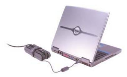
AC アダプタは AC 電力をコンピュータに必要な DC 電力へと変換します。AC アダプタは、コンピュー 夕の電源のオンまたはオフにかかわらず接続できます。
