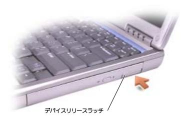
2 リリースラッチを持ってデバイスを引き出し、モジュールベイからデバイスを取り外し ます。
