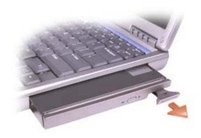
3 ベイに新しいデバイスを挿入し、カチッという感触が持てるまでデバイスを押してから、 デバイスリリースラッチを押し込み、デバイスがコンピュータと揃うようにします。
